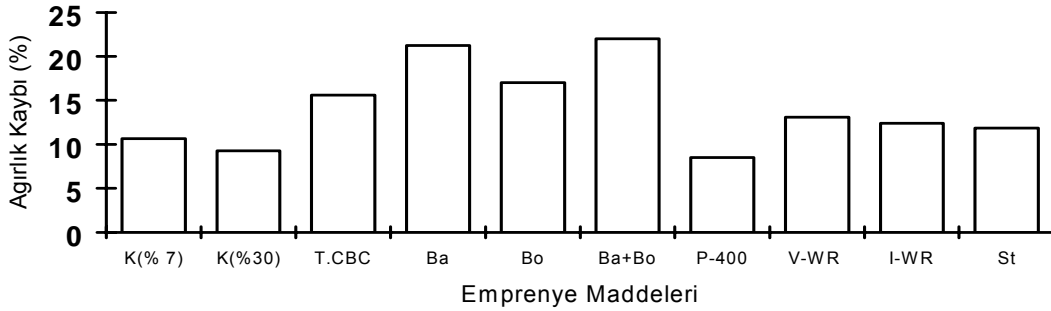
Şekil 2. Yanma Sonucu Oluşan Ağırlık Kayıpları
