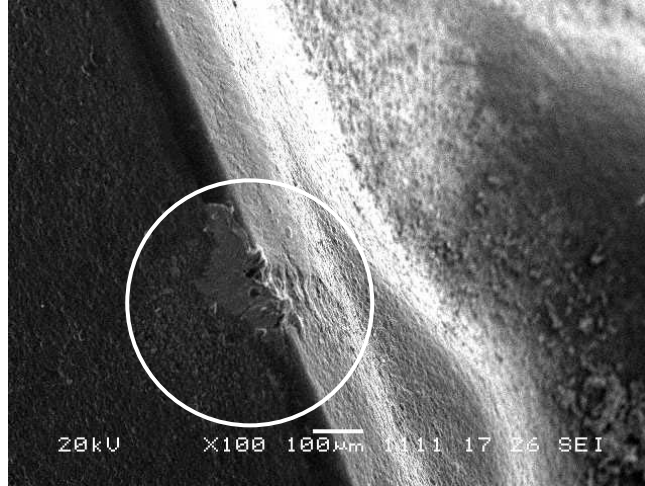
Şekil 3. AISI 304 Malzemenin Ticn/Tic/Al 2 O 3 Kaplanmış Sementit Karbür Kesici Takımla 210 M/Dk Kesme Hızında İşlenmesi Sonucu Kesici Takıma Yapışan İş Parçası Malzemesini Gösteren SEM Fotoğrafi
