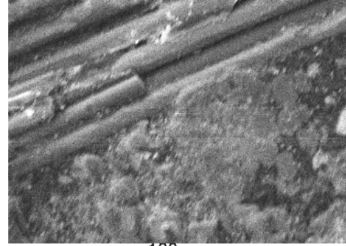
Şekil 5. CF kodlu numunenin mikro yapı resimleri a) CF11 normal b) CF112 fırınlanmış
